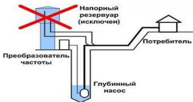
Водоснабжение правобережной стороны села Коелга – осуществляется при помощи шкафа управления насосом. Задача автоматического блока обеспечить максимально плавный пуск, позволяющий избежать гидравлического удара и выхода из строя двигателя работоспособности.
